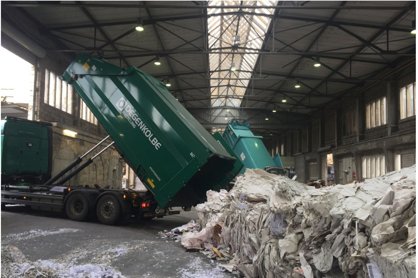
Abkippen zweier Selbstpresscontainer in der Anlieferung
