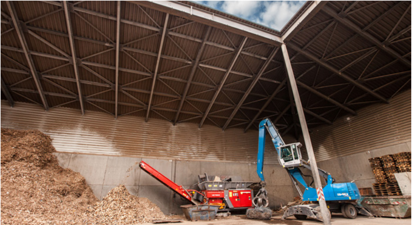
DER ELEKTROSHREDDER BEI KARLE RECYCLING ZERKLEINERT DURCHSCHNITTLICH 20 TONNEN UNBELASTETES HOLZ PRO STUNDE.
