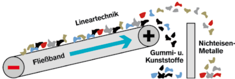
Schematische Darstellung der Shredder-Anlage in Herbertingen – Teil 2
