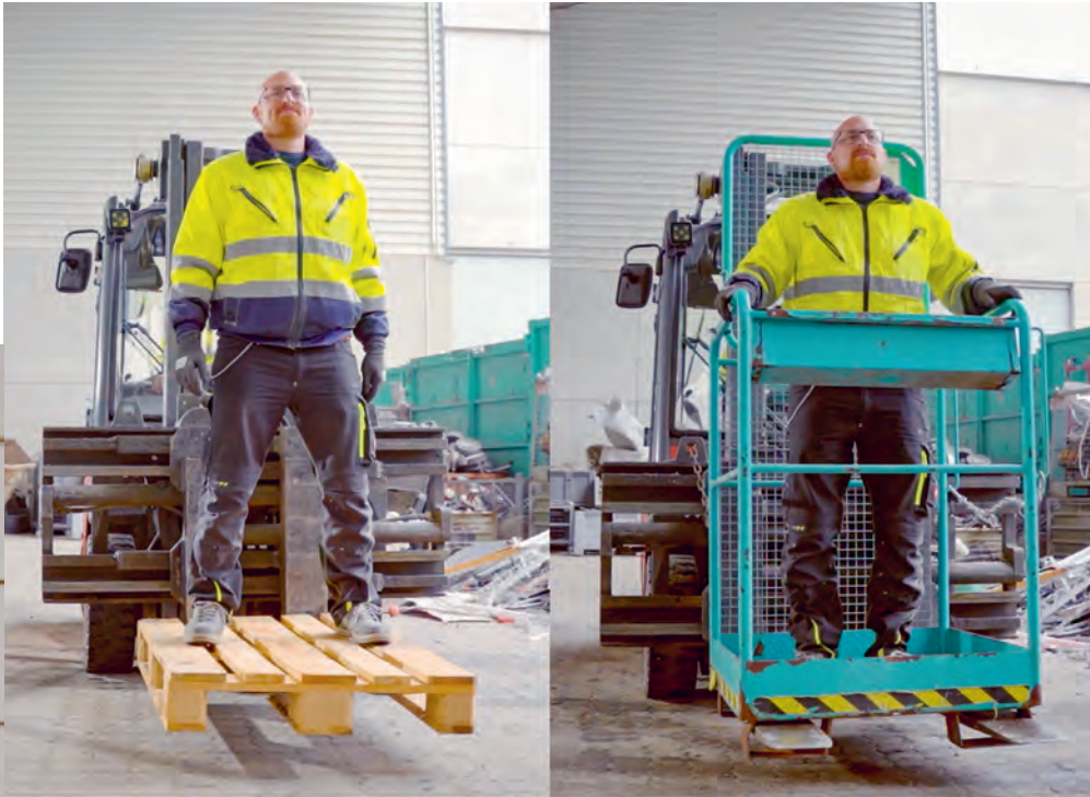
Das ungesicherte Anheben von Personen (links) mit einem Gabelstapler ist verboten. Ein Sicherheitskorb sorgt für unfallfreies Arbeiten in der Höhe.
