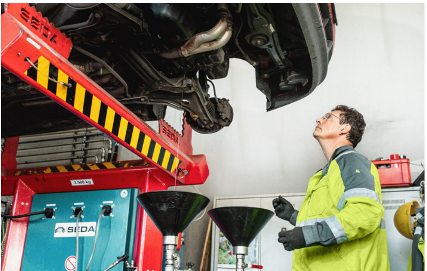
Vor der Demontage werden die Altautos trockengelegt.
